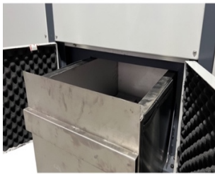
全封闭废料仓
